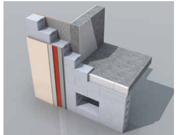
Izolacija toplinskog mosta, čela, armirano betonske ploče, Multipor pločom Ytong L-profilom.
